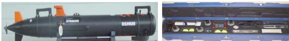
**背景：**MK 18 MOD 1剑鱼无人潜航器是给NSCT ONE和EOD配备的工具箱中的一部分。它能够在极浅水域 (VSW) (10~40 FSW) 和通海航道区域进行低能见度的探测和侦察，为两栖登陆舰登陆，反水雷作战和水文绘图提供支援。其特点是，体积小 (两人便捷式)、造价低 (无意丢失也不会对部队造成灾难性的损失)，能够用于多用途平台。达到全面作战能力后，首批三套系统中的第二、第三套交付给了NSCT ONE。另外的系统将用于EOD进行中国大陆以外 (OCONUS) 的支援工作。该系统可以通过声频收发器在长基线或者超短基线模式下，或者通过P码GPS进行导航定位。上视和下视声学数字计程仪能够改进艇上惯性导航的精准度。舰载传感器包括水流混浊、水流温度和导热性测量仪、侧扫声呐以及下视摄像机。
